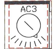
Calibrer le disjoncteur en fonction de la puissance de la pompe
